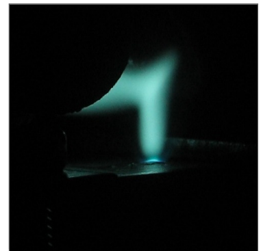
Abbildung 2: Wechselwirkungen zwischen einem Lichtbogen und dem Laserstrahl
