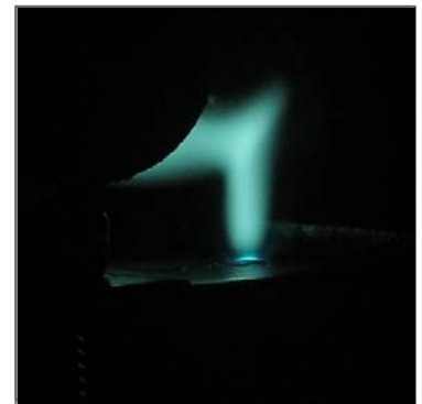
Abbildung 2: Wechselwirkungen zwischen einem Lichtbogen und dem Laserstrahl
