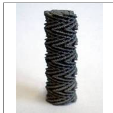
Abbildung 3: Demonstrator eines gradiert-porösen Zahnwurzelimplantats
