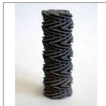
Abbildung 3: Demonstrator eines gradiert-porösen Zahnwurzelimplantats
