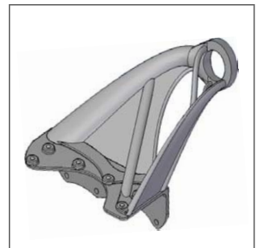
Abbildung 3: Gewichtsoptimiertes Bauteil für die lasergenerative Fertigung
