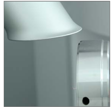
Abbildung 1: Mikroperforation des Werkzeugeinsatzes mit einem Pikosekundenlaser
