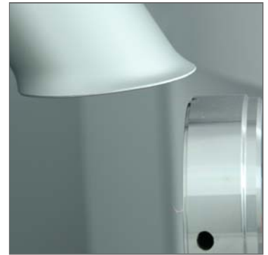
Abbildung 1: Mikroperforation des Werkzeugeinsatzes mit einem Pikosekundenlaser
