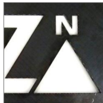
Abbildung 2: Mittels Laser getrennte CFK-Struktur, Vorschub 5 m/min (LZN)
